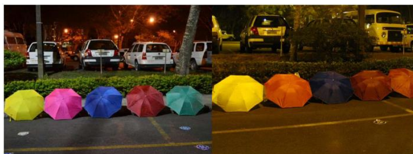
Figura 1 - Comparativo entre duas fontes luminosas com diferentes IRC’s. Fonte: General Eletric (2011).
